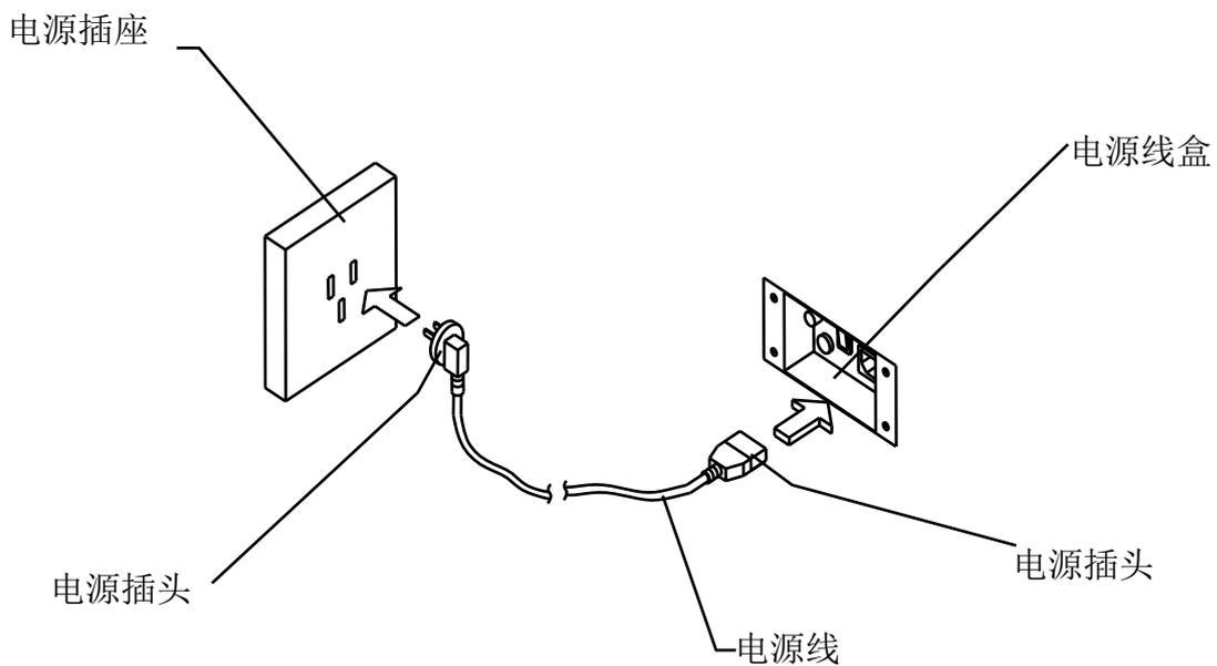
**⚠ 警告：**本机器的工作电压为 220V，请根据机器标识的电压接入电源，否则可能造成机器损坏。
