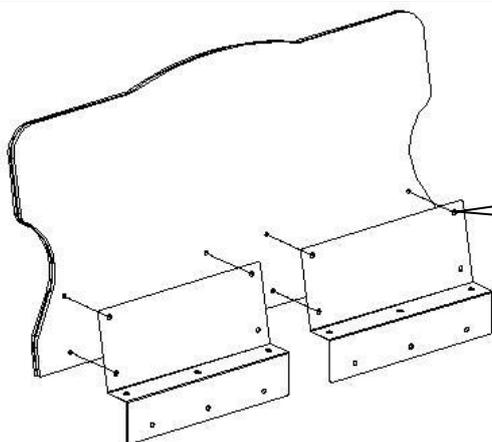
安装木板支架，使用 M6 的十字槽盘头套件螺钉，数量为 8
