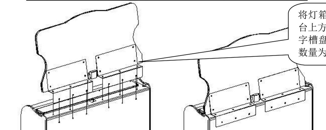
将灯箱木板安装在机台上方，使用 M6 的十字槽盘头套件螺钉，数量为 12
