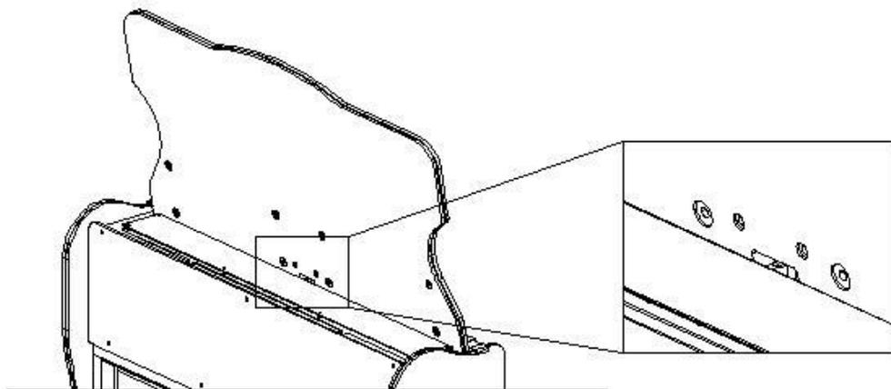
安装时注意灯箱木板中间的过线孔，防止将线路压住。
