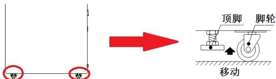
机台在近距离移动时把地脚调整座升高让脚轮接触到地面推动机台即可。
